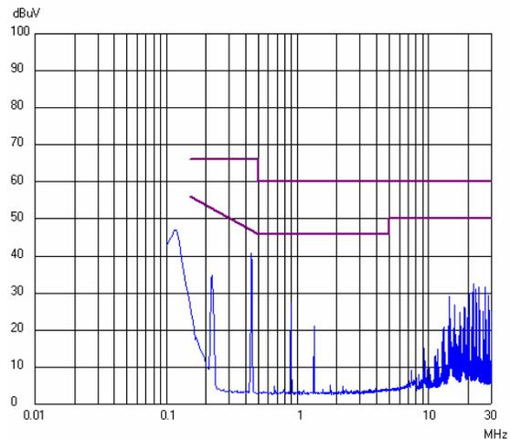
$V_{in}=48\text{V}$ ,  $P_o=15\text{W}$ , average mode
