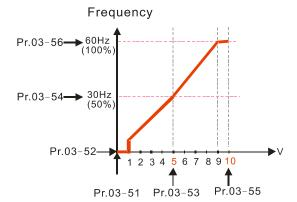
Pr.03-51=0V; Pr.03-52=10% Pr.03-53=5V; Pr.03-54=50% Pr.03-55=10V; Pr.03-56=100%
