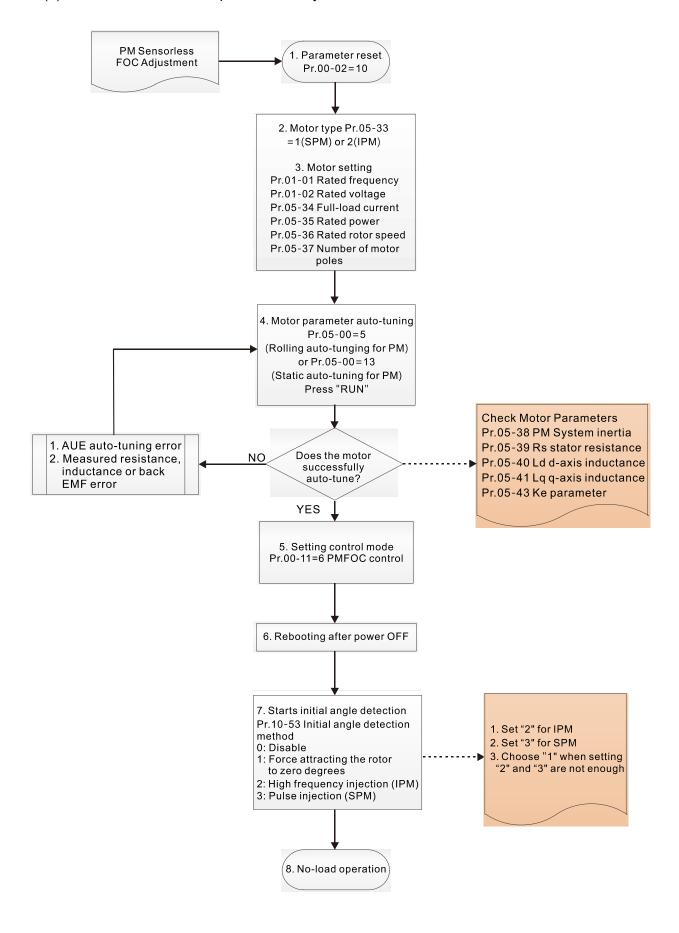
Motor parameters adjustment
