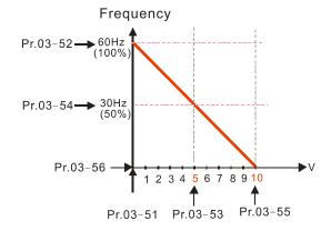
Pr.03-51=1V; Pr.03-52=10% Pr.03-53=5V; Pr.03-54=50% Pr.03-55=10V; Pr.03-56=100% Pr.03-51=1V; Pr.03-52=10% Pr.03-53=5V; Pr.03-54=50% Pr.03-55=9V; Pr.03-56=100%
