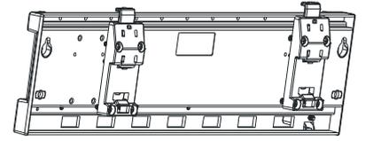
TR 35mm DIN rayları için geçerlidir. Ray klipslerini alt panel üzerine yerleştiriniz.
